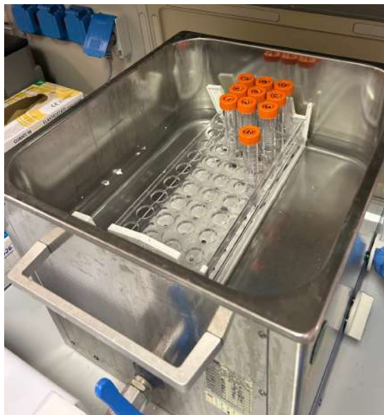
Figura 55 I tubi che contenevano gli impianti vengono sonicati in un bagno ad ultrasuoni a 47kHz, 234W per 6min
