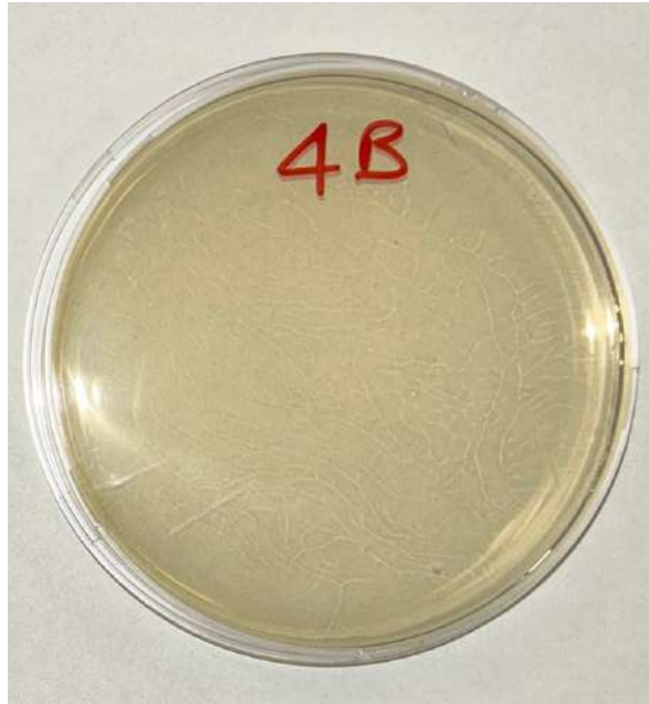
Figura 65 Piastra seminata con sospensione diluita 1:10 ottenuta dal trattamento dell'impianto numero 4 con EC-STER
