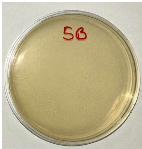
Figura 66 Piastra seminata con sospensione non diluita e diluita 1:10 ottenuta dal trattamento dell'impianto numero 5 con EC-STER
