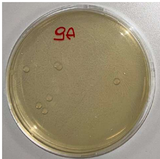
Figura 70 Piastra seminata con sospensione non diluita ottenuta dal trattamento dell'impianto numero 9 con argento colloidale
