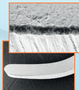
Bordo tagliente della curette LM Sharp Diamond™ e ingrandimento del tagliente dopo il test.
